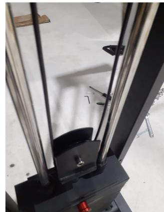
**PASSO 47: Infilare il tirante del cavo nella parte superiore**
