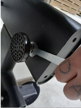
**PASSO 6: Vista del telaio con staffa del piede montata**
